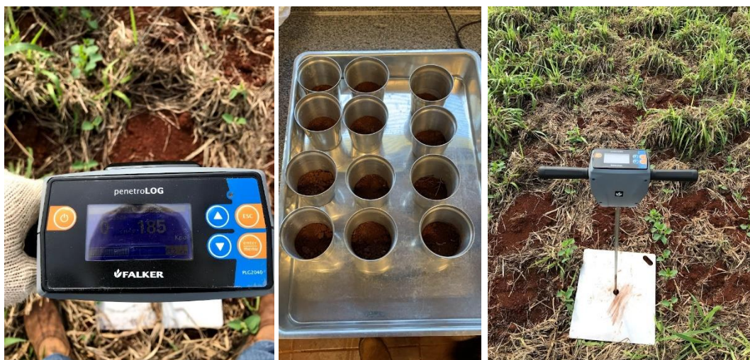
Figura 5. Coleta de dados da resistência a penetração do solo através do penetrógrafo Falker® e umidade do solo, na área Experimental da Embrapa Agropecuária Oeste, Dourados – MS, 2023.
